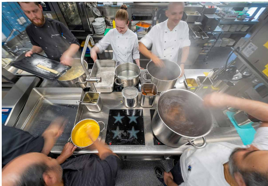
Plaque de gril, plans de cuisson à induction, bain-marie, salamandre, armoires Cook & Hold, four, armoire chauffante – la cuisinière à induction conçue par Menu System AG et produite à Saint-Gall contient tout ce qu'il faut pour le quotidien d'un cuisinier professionnel.
